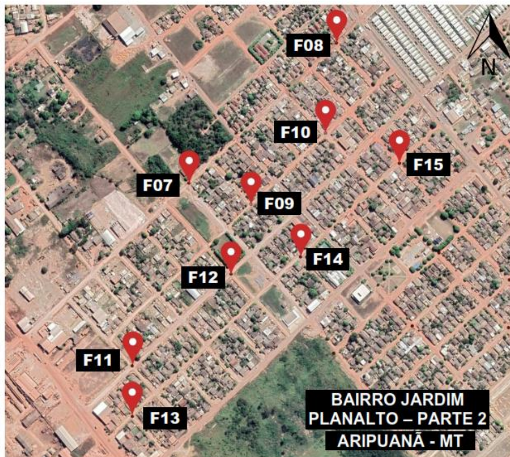
Plano de sondagem do subleito – Parte 2
